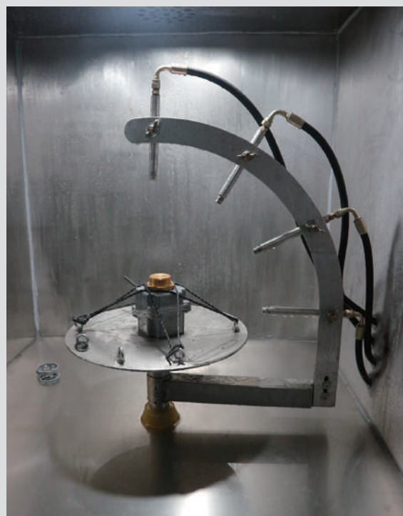
Alloggiamento durante il test IPx9k
