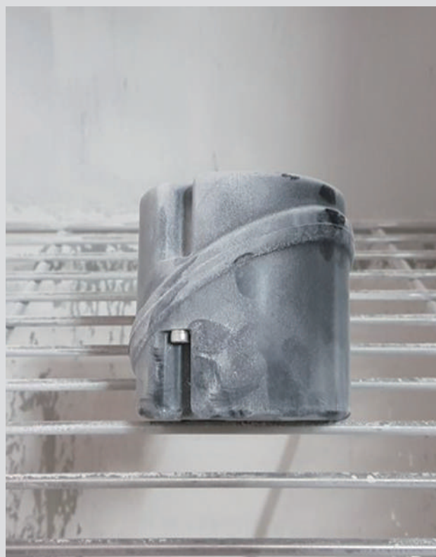
Alloggiamento durante il test IP6x
