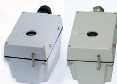
Dopo 1000 ore (fianco a fianco con un prodotto non sottoposto a UV)
