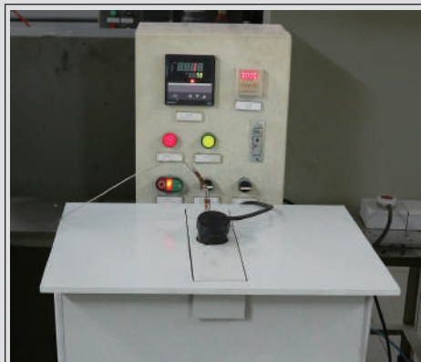
Bagno di test all'ipocloruro di sodio
