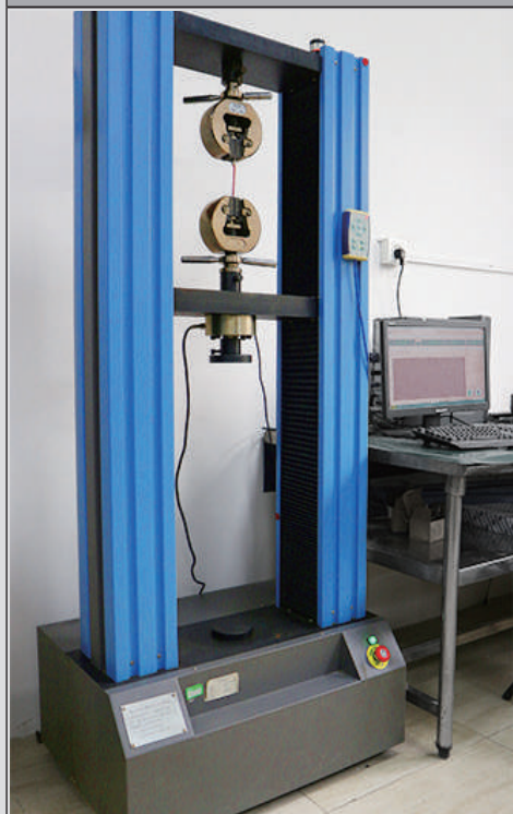
Banco di test di trazione
